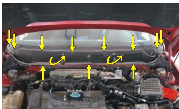
(PL) Odkręcić wkręty mocujące maskownicę podszybia. Zdemontować element maskownicy podszybia
